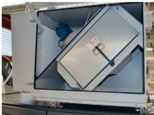
Der Ventilator als einzige bewegliche Einheit ist auf der sauberen Filterseite platziert, um vor möglichen Belastungen geschützt zu sein.
