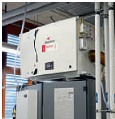
Der Ölnebelfilter «A-mist 10C » kann einfach auf die Werkzeugmaschine aufgesetzt werden.
